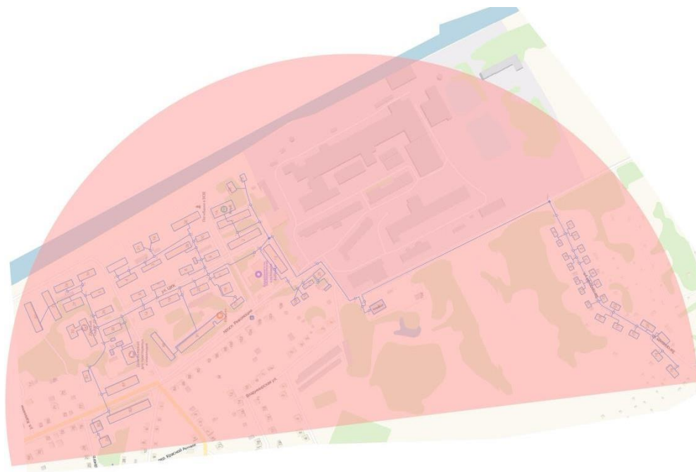
Рисунок 95. Радиус эффективного теплоснабжения котельной мкр. ЦКК
