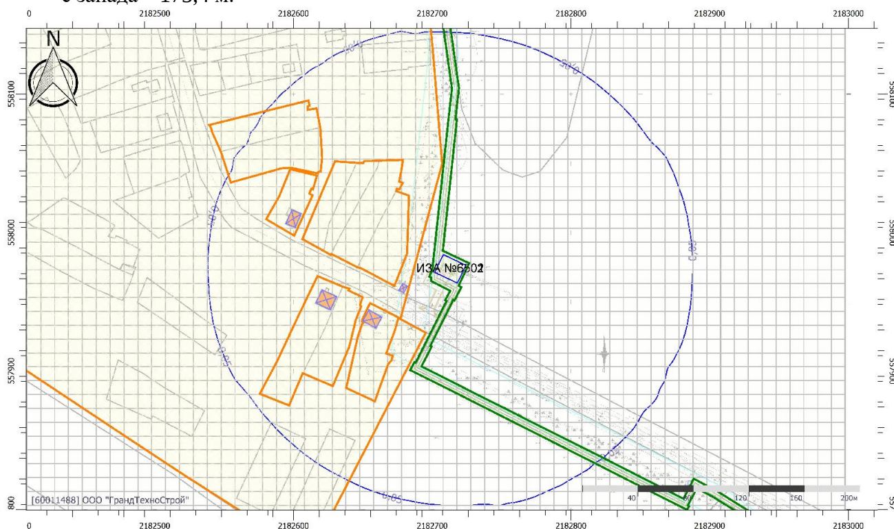
Рисунок 4 – Карта-схема распределения изолиний максимально-разовых концентраций ЗВ при производстве работ в период строительства
