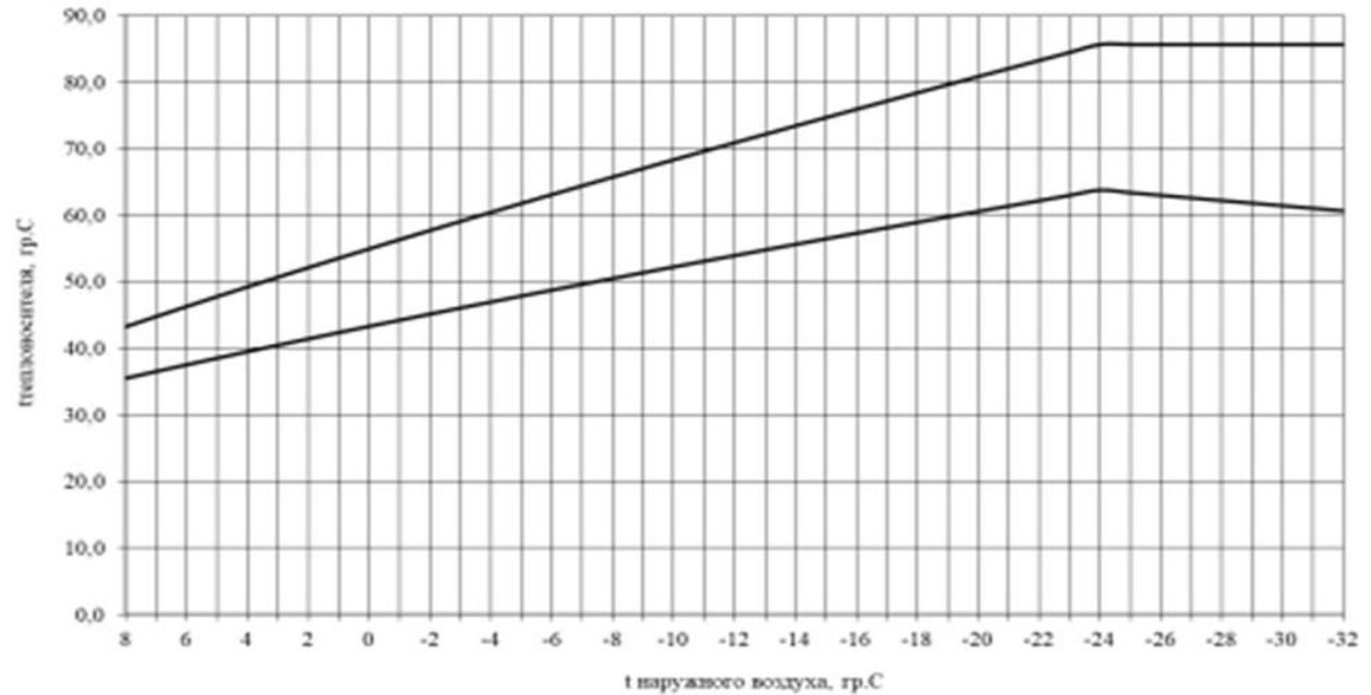
Рисунок 28. Температурный график тепловой сети с котельной №4 (р. п. М. Козино, ул. Докучаева)
