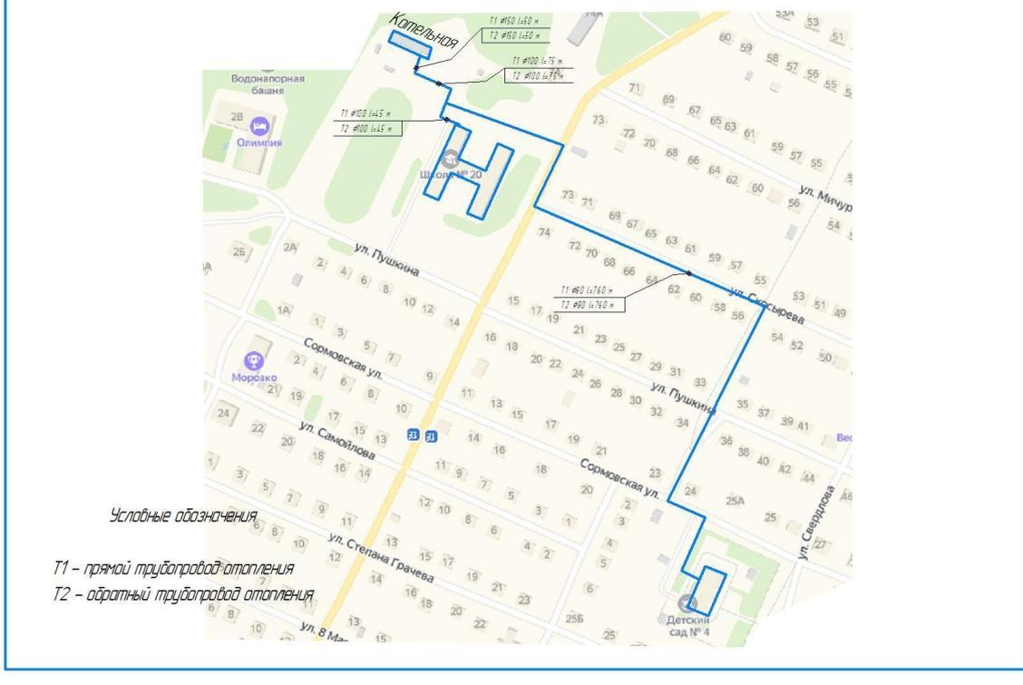
*Рисунок 20. Схема тепловых сетей от котельной ул. Пушкина*
