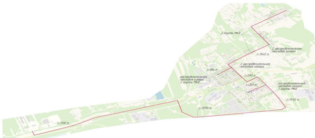
*Рисунок 9б. Планируемая схема размещения тепловых сетей в поселке Гидроторф от ООО «ТЕХНОПАРК Реал-Инвест»*
