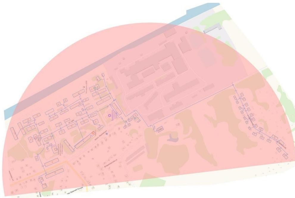
*Рисунок 95. Радиус эффективного теплоснабжения котельной мкр. ЦКК*
