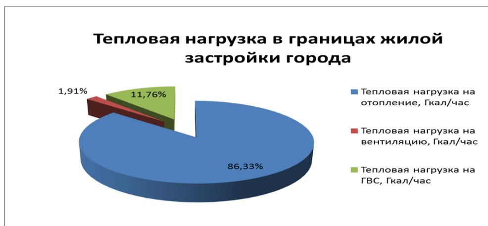
*Рисунок 40. Тепловая нагрузка в границах жилой застройки*
