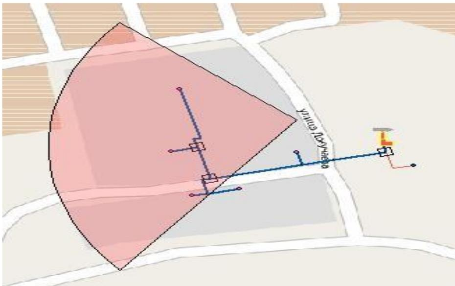
*Рисунок 85. Радиус эффективного теплоснабжения котельной №4*
