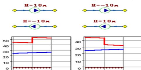
Рисунок 69. Пьезометрические графики
