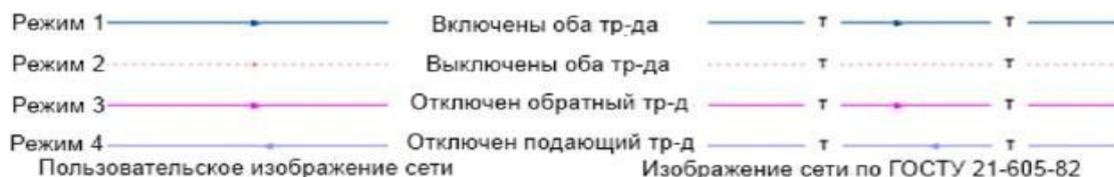
Рисунок 56. Изображение нескольких состояний участков, задаваемых разными режимами
