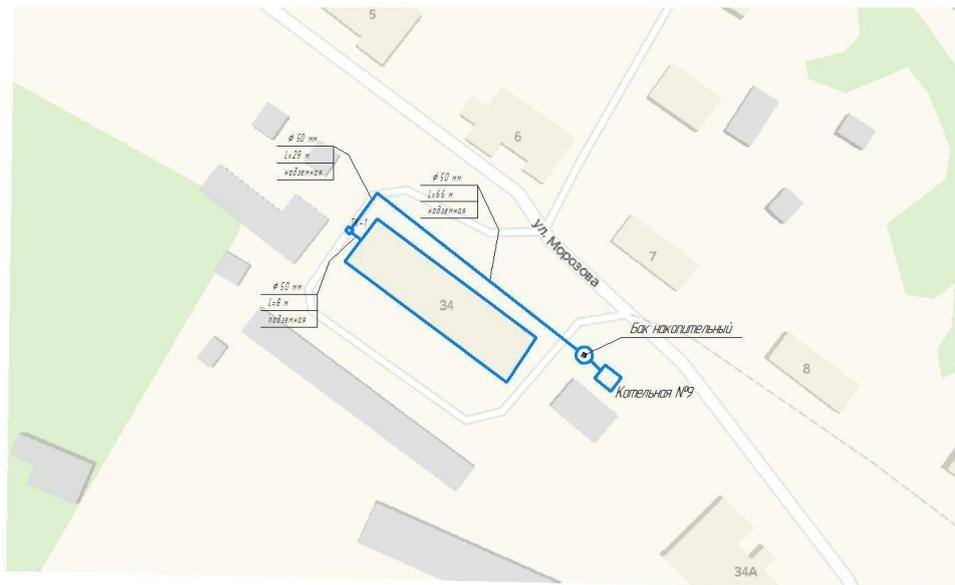
Рисунок 12. Схема тепловых сетей от котельной №3
