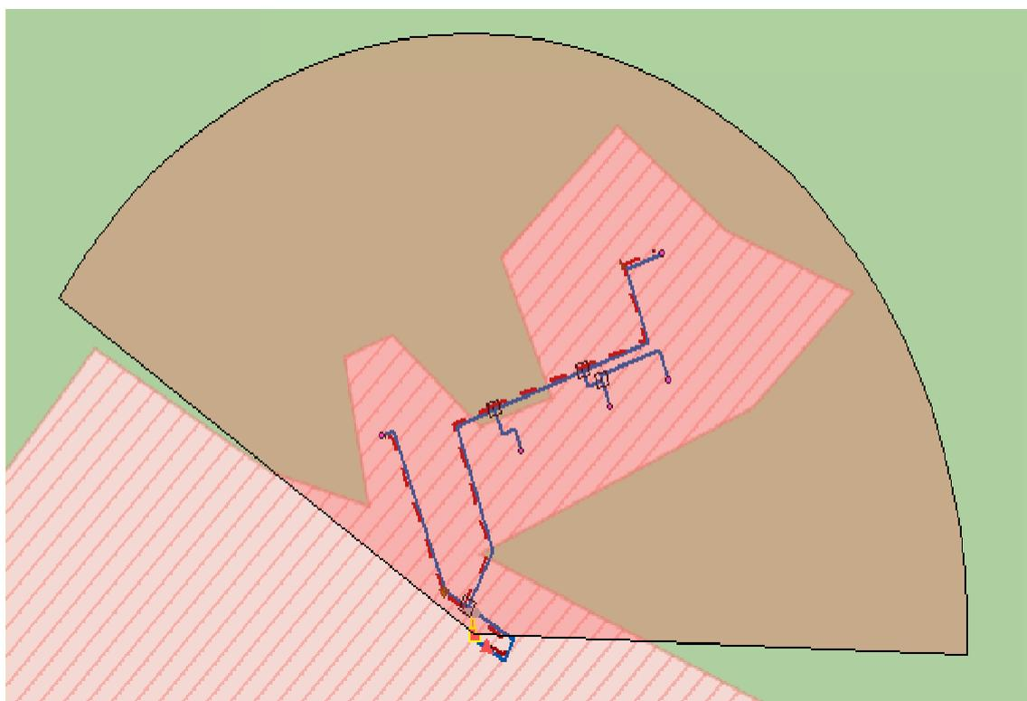
*Рисунок 94. Радиус эффективного теплоснабжения котельной ул. Воинская*
