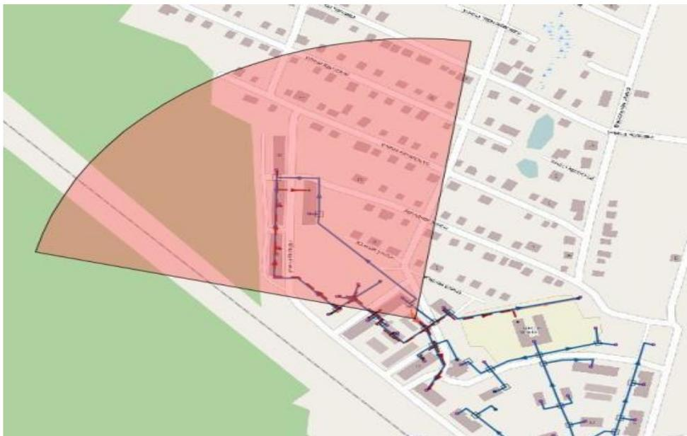
*Рисунок 83. Радиус эффективного теплоснабжения котельной №2*
