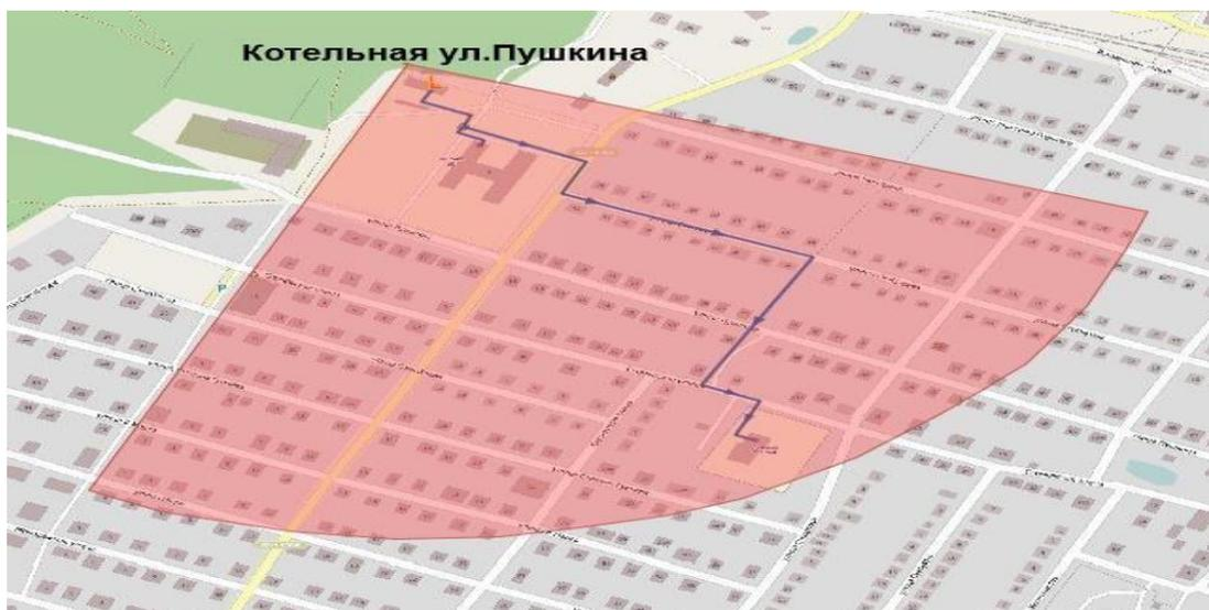
*Рисунок 93. Радиус эффективного теплоснабжения котельной ул. Пушкина*
