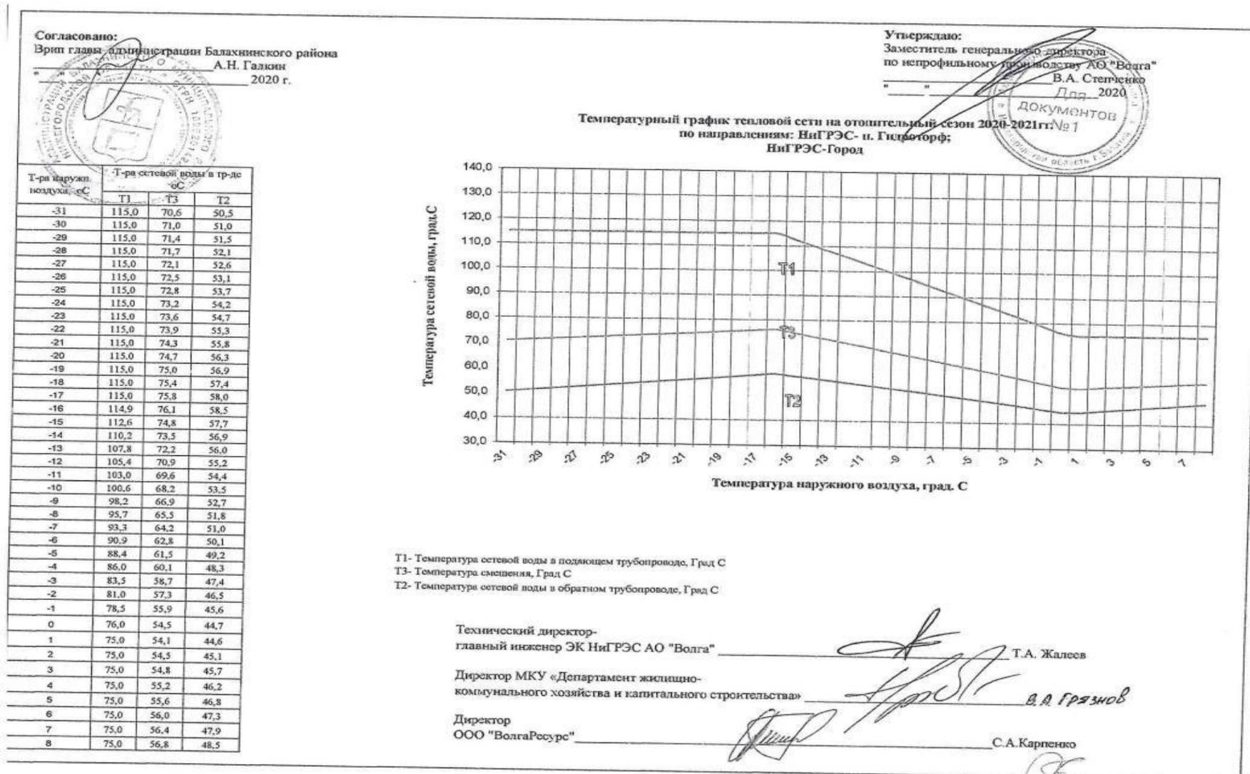
Рисунок 24. График регулирования отпуска тепловой энергии от ООО «ВолгаРесурс» НиГРЭС – и. Гидроторф
