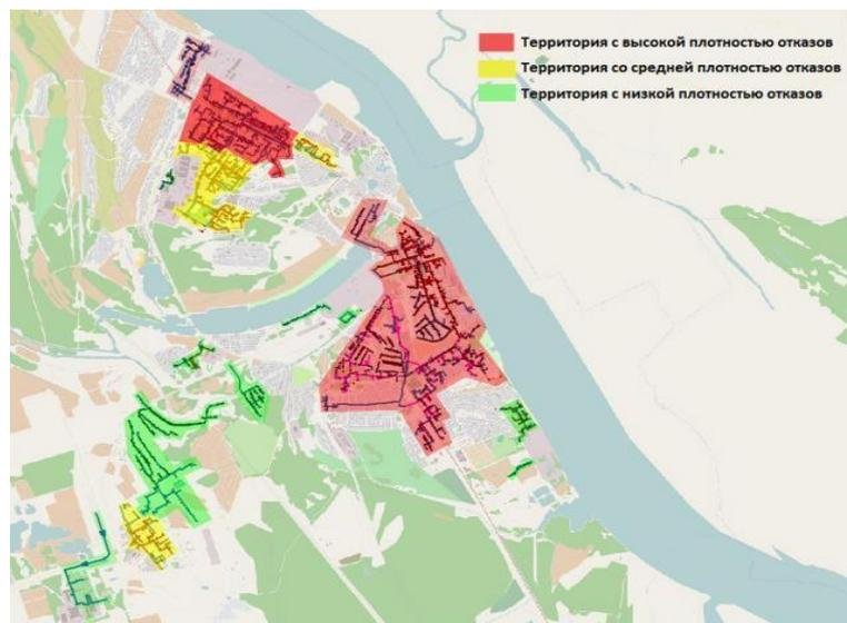
Рисунок 47. Карта-схема тепловых сетей и зон ненормативной надежности и безопасности теплоснабжения ДТ
