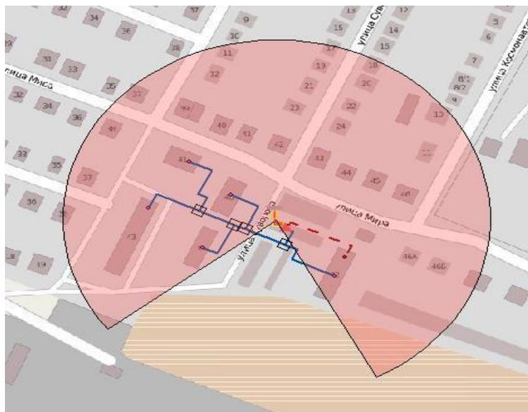
*Рисунок 91. Радиус эффективного теплоснабжения котельной ул. Олимпийская*
