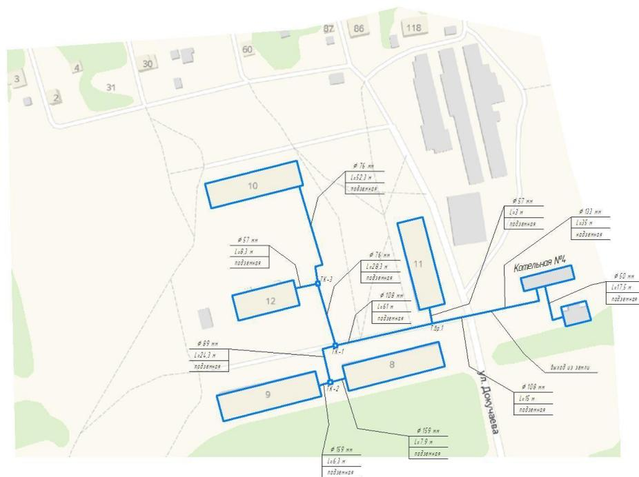
Рисунок 13. Схема тепловых сетей от котельной №4
