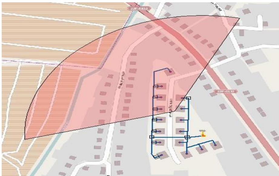
*Рисунок 86. Радиус эффективного теплоснабжения котельной №9*
