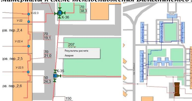
В окне по работе с авариями выводится перечень запорной арматуры, необходимой для изолирования аварийной зоны. Перечень формируется автоматически на основании анализа схемы. При этом учитывается состояние запорной арматуры - исправна / неисправна, указанное в паспортной форме данного элемента.
