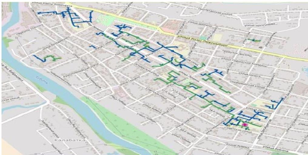
*Рисунок 54. Изображение тепловой сети на карте с привязкой к местности*
