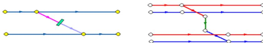
Рисунок 67. Соединение между подающим трубопроводом одного участка и обратным трубопроводом другого участка
