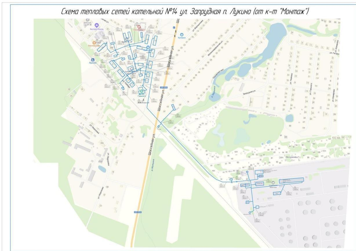
*Рисунок 17. Схема тепловых сетей от котельной №14*
