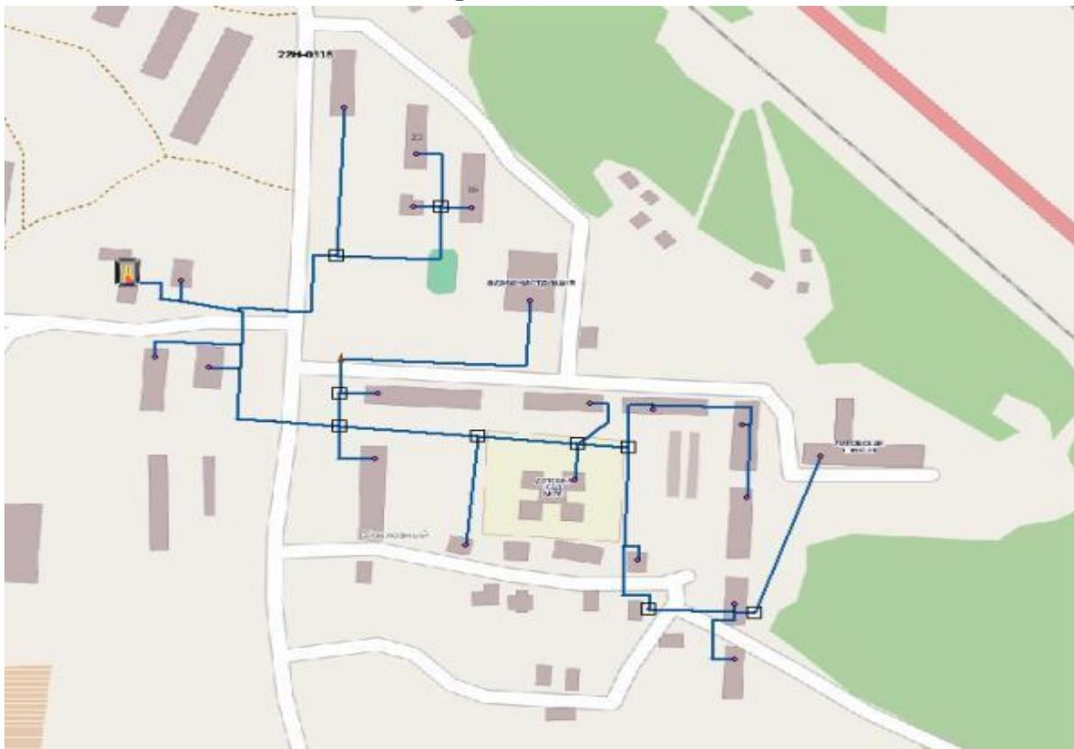
*Рисунок 16. Схема тепловых сетей от котельной пос. Совхозный*
