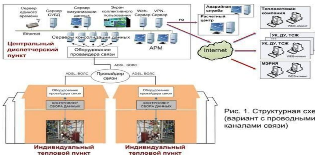
Рис. 1. Структурная схема (вариант с проводными каналами связи)
