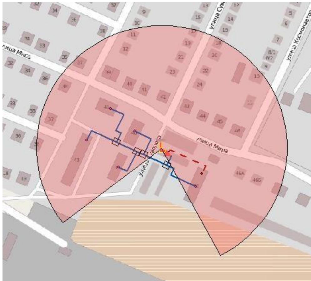
Рисунок 16. Радиус эффективного теплоснабжения котельной ул. Олимпийская
