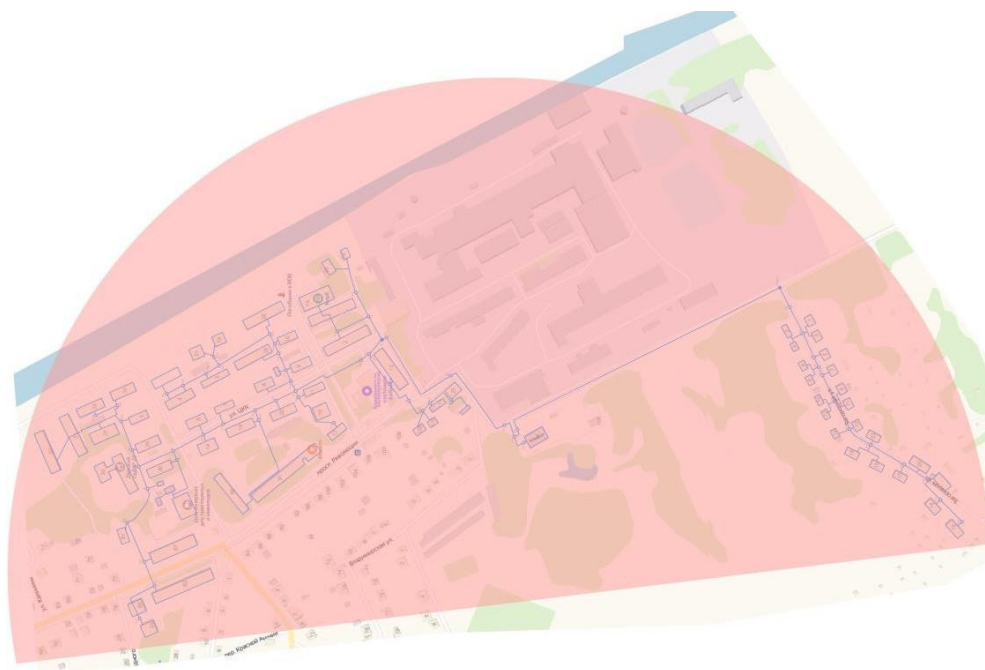
Рисунок 20. Радиус эффективного теплоснабжения котельной мкр. ЦКК
