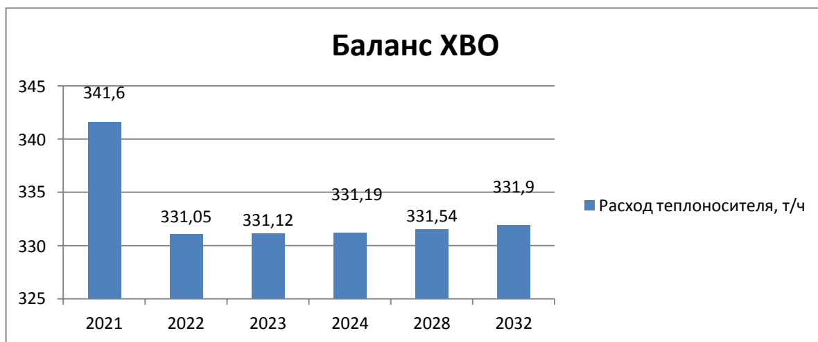
Рисунок 21. Перспективная производительность водоподготовительной установки
