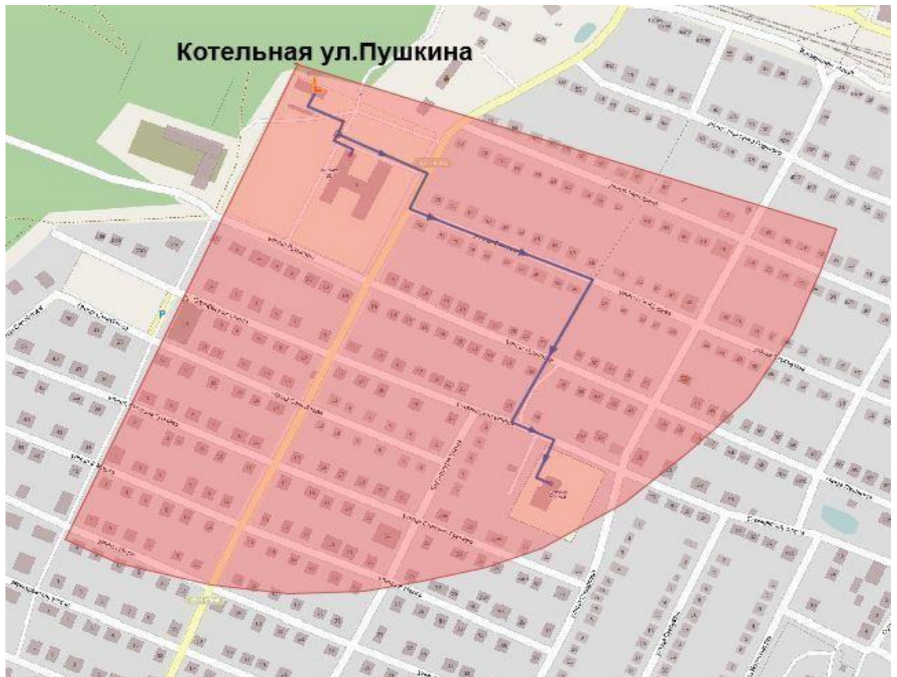
Рисунок 18. Радиус эффективного теплоснабжения котельной ул. Пушкина
