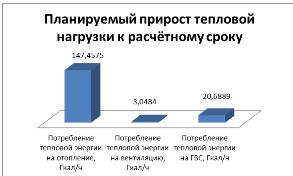
Рисунок 3. Планируемая тепловая нагрузка к расчетному сроку
