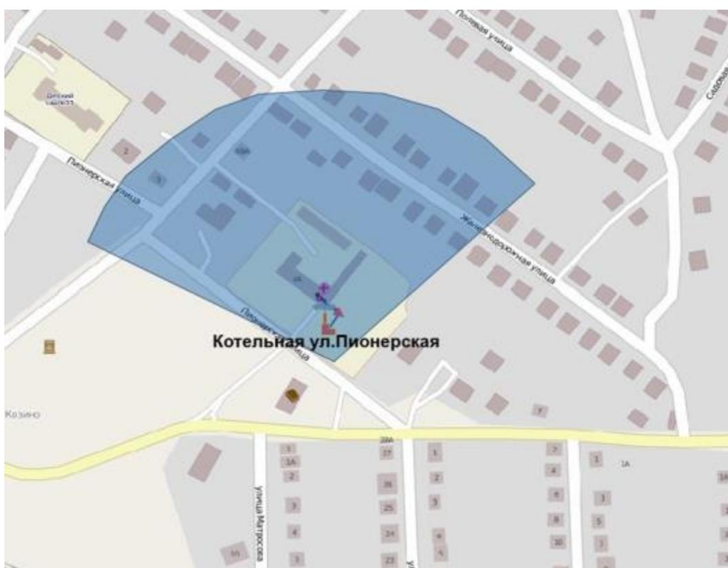
Рисунок 17. Радиус эффективного теплоснабжения котельной ул. Пионерская
