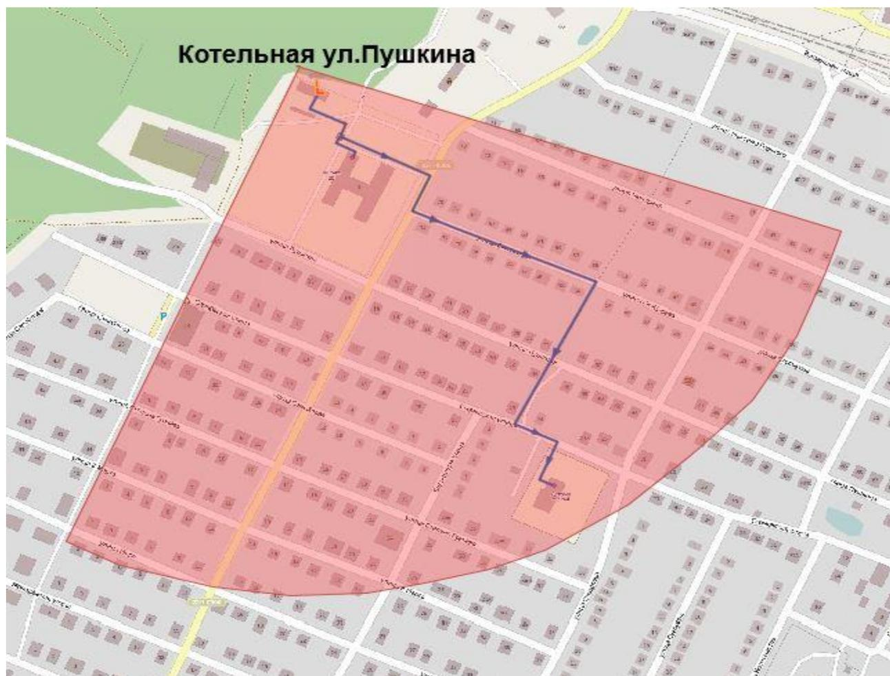
Рисунок 18. Радиус эффективного теплоснабжения котельной ул. Пушкина
