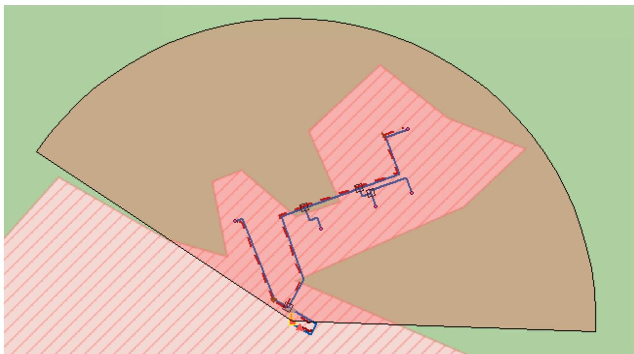
Рисунок 19. Радиус эффективного теплоснабжения котельной ул. Воинская
