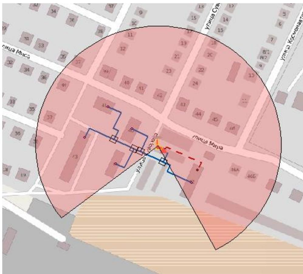
Рисунок 16. Радиус эффективного теплоснабжения котельной ул. Олимпийская
