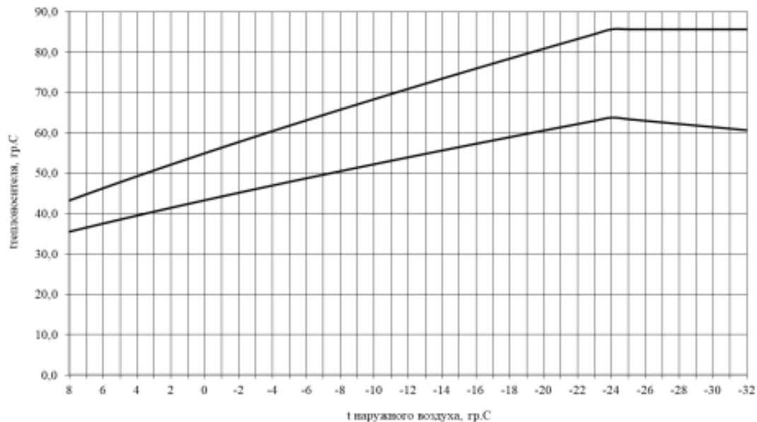
*Рисунок 24. Температурный график тепловой сети с котельной №4 (р. п. М. Козино, ул. Докучаева)*
