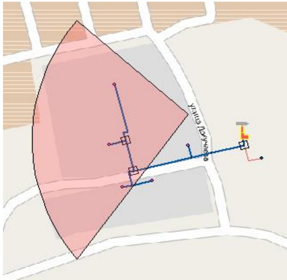
Рисунок 10. Радиус эффективного теплоснабжения котельной №4
