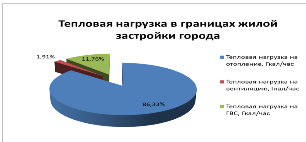
Рисунок 38. Тепловая нагрузка в границах жилой застройки
