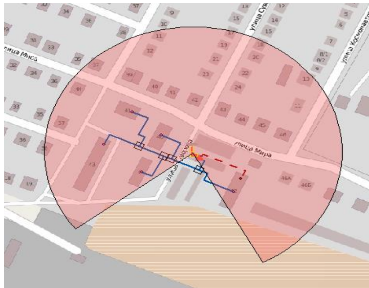
Рисунок 89. Радиус эффективного теплоснабжения котельной ул. Олимпийская
